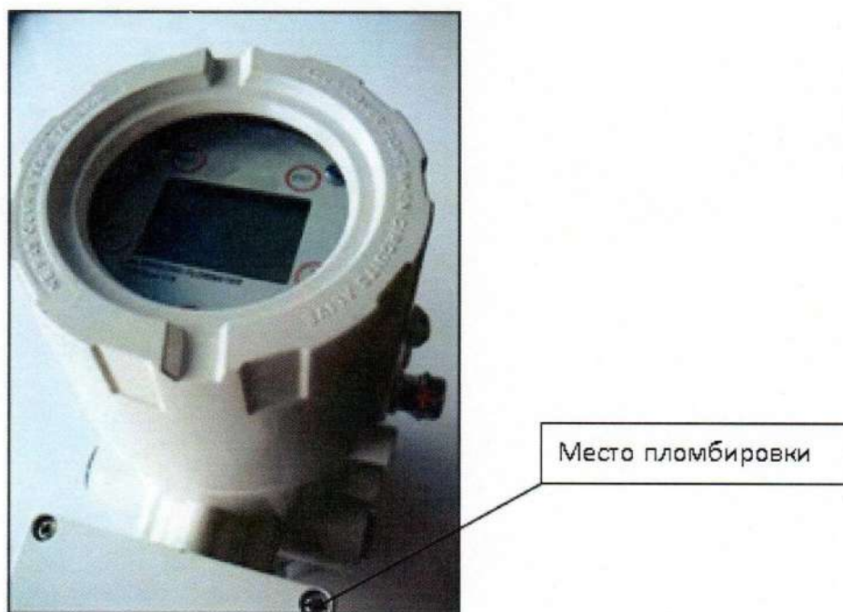
Рисунок 4 – Внешний вид и схема пломбировки вторичного преобразователя расходомера газа ультразвукового «Руна УНЛ-260-ВП-Exde»
